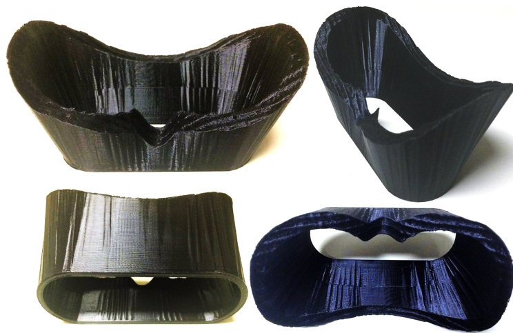
Figure 6.6: Une version imprimée en plastique NinjaFlex d'un casque VR pour le visage de Chaima El Asmi.
